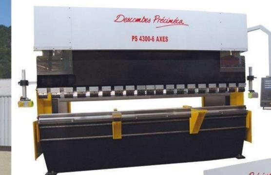
Presse plieuse à butée mécanique
